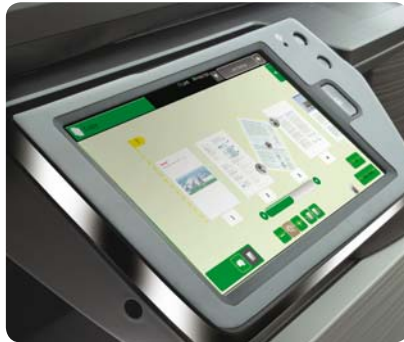
Panel sterowania „finger-swipe” z możliwością odchylenia ułatwia przeglądanie i edycję stron
